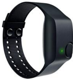
Fig. 2. Empatica E4 EDA & HRV Sensor
