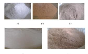
(d) (e) Fig. 1. Ground Construction Waste Materials (a) Waste glass Powder (b) Waste Brick Block Powder (c) Waste Brick Tile Powder (d) Waste Sandcrete Hollow Block Powder (e) Synergy of (a), (b), (c), and (d)
