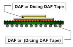
Fig. 1. Die Attach Film.
