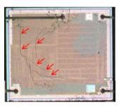
Fig. 2. Circular die crack.
