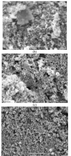
(d) Fig. 4. The SEM image of ZnO thin films (a) at 300  $^{\circ}$ C (b) at 400  $^{\circ}$ C (c) at 500  $^{\circ}$ C and (d) at 600  $^{\circ}$ C
