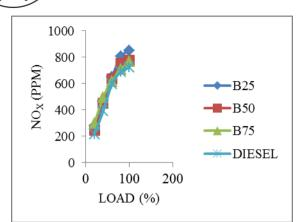
Graph 4.9. Load V<sub>S</sub>NO<sub>X</sub> at 210 bar & 21° btdc.
