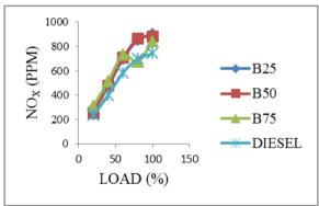
Graph 4.5. Load V<sub>s</sub> NO<sub>x</sub> at 200 bar & 23° btdc.
