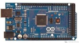
Fig. 2. Arduino mega 2560.
