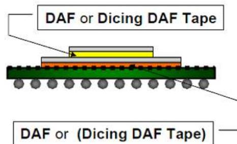
Fig. 1. Die Attach Film.
