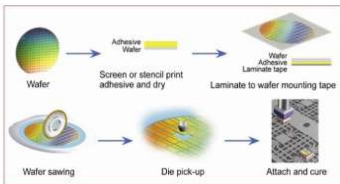
Figure 2. Die Attach Film
