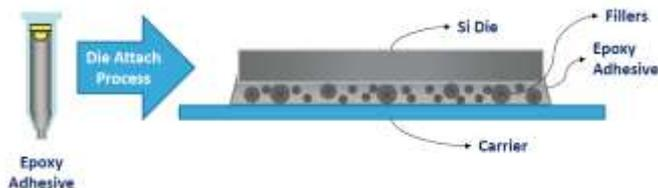
Fig. 1. Die Attach Epoxy Adhesive
