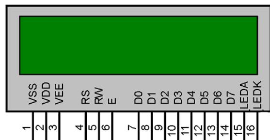
Fig. 7. LCD display.
