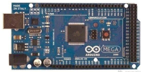
Fig. 2. Arduino mega 2560.
