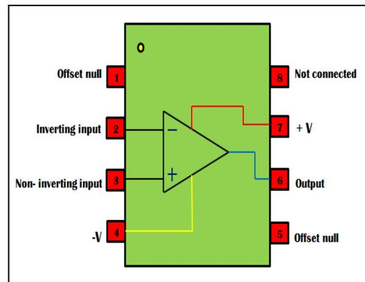
Fig. 4. Pin diagram opamp IC  $\mu A-741$ .
