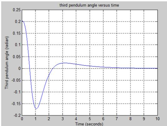
Fig. 2(d). Step response of 3<sup>rd</sup> angle.
