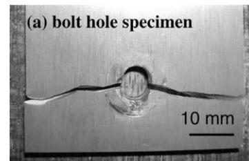
a. Experimental test specimen.
